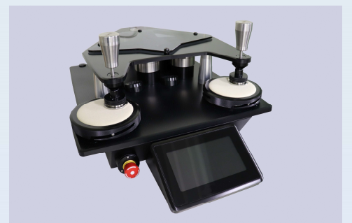
図2 マーチンデール摩耗試験機 （令和6年12月に当センターに導入！）
