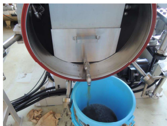
図2 装置による抽出と染色
