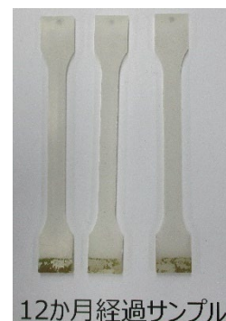
写真 暴露後の試験片 左PP, 右 CNF/PP
