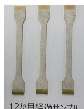
写真 暴露後の試験片 左PP, 右 CNF/PP
