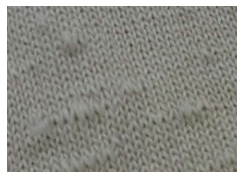
楕円形の糸の浮き (綿: S方向に上撚り400T/m以上)
