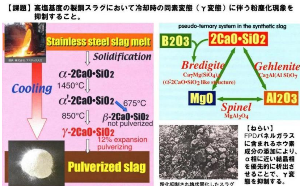
図1 製鋼スラグの粉化機構とホウ素成分添加による塊状固化原理
