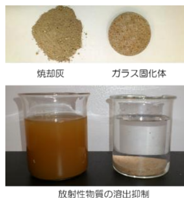
図 2. 放射性物質の溶出抑制効果 Fig. 2. Suppression effect of radioactive substance elution
