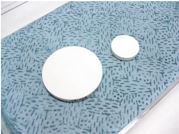
図1 液晶パネルガラスを用いたガラスセラミックス Fig. 1. Glass-ceramics using LCD panel glass
