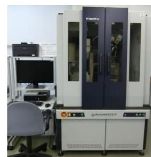
微小部X線残留応力測定装置による
