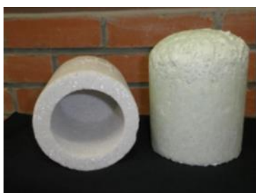
脱型後、内部加工
