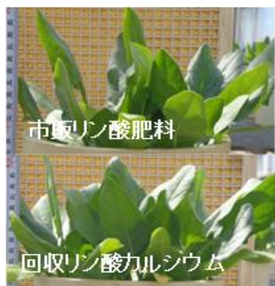
図 1: ブラウン管パネルガラスを原料としたリン酸吸着材 図 2: リン酸リサイクルシステムの概念図 図 3: 回収されたリン酸を原料としたリン酸肥料の効果試験 (ホウレンソウを用いた栽培試験)
