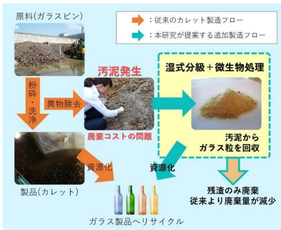
図 1. ガラスカレット製造への本技術を導入したイメージ
