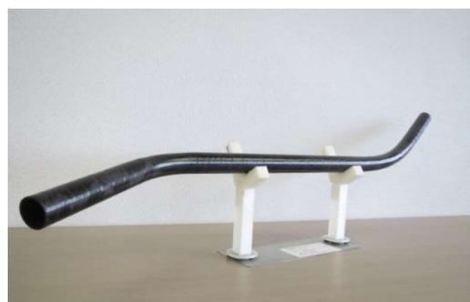
3D形状曲げCFRTPパイプ
