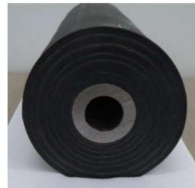
肉厚CFRP軸構造体
