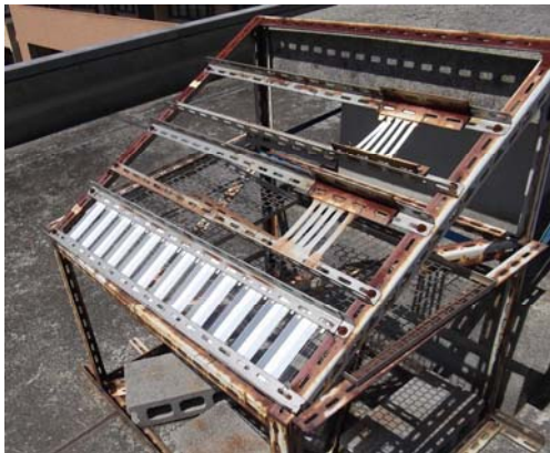
図1 大気暴露試験の設置の様子(最下段)
