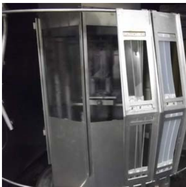
図2 促進耐候性試験機の設置の様子
