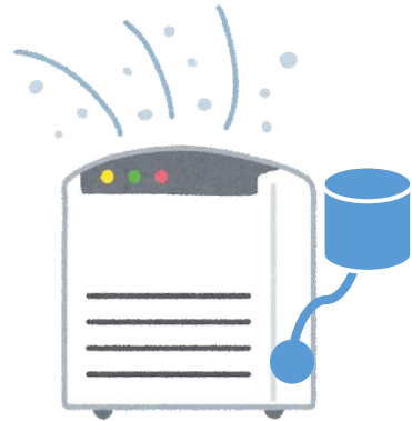
差圧センサー： フィルター目詰まりの管理
