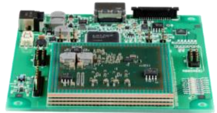
電気接続性評価のために作製した三次元モジュール
