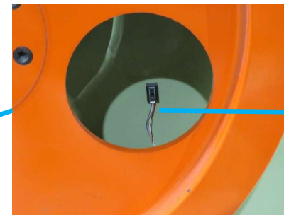
赤外線距離センサの設置例
