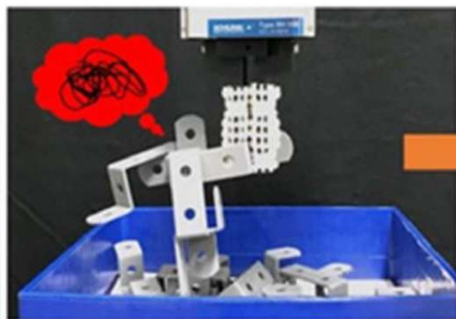
通常は絡んで作業できないような扱うのが難しい部品
