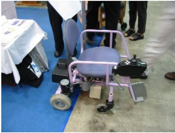
車椅子取り付け式の雪道移動用補助動力ユニット（北海道立工業試験場）
