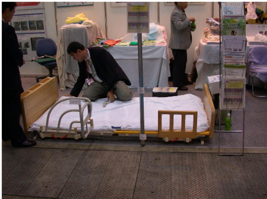
介護ベッドを使用する高齢者には、布団で寝るといった従来の就寝環境への要望が強くあるが、現在の介護ベッドは、布団で就寝しているような高さまで下降せず、使用者は、不満を抱えながら使用している。また、介護者にとっては、介護作業における身体負担を低減するために、ベッドの高さは、高い位置で使用したいという要望がある。そこで、在宅介護、及び施設での個室使用に供することを前提に、介護する側、介護される側双方に優しい介護ベッドを開発した。本ベッドは2m×1mの床面を持ち、特徴としては、空気圧を使用してベッド床面が上昇、下降し、就寝時は、ベッドの床面高さを極力低くすること(15cm)で、和室等の従来の就寝環境の維持を図りつつ、転落による身体損傷を低減し、立ち上がり時や介護時には、ベッド床面を必要な高さまで上昇すること(最大600mm)で、立ち上がりの補助や介護者の負担の軽減が
