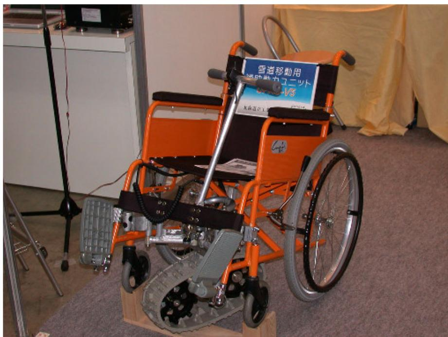
前輪が埋まったり、雪による抵抗の増大により、手動式車椅子の積雪路面走行には困難が伴います。そこで手動式車椅子の座席下部に装着可能なゴムクローラ式電動ユニットを開発しました。ハンドルにはクローラの左右とピッチングを同時に操舵出来る独自の機構を採用し、凹凸のある積雪路面は勿論のこと、悪路や砂浜等も安定して走行できることを確認しました。
