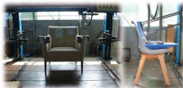
JIS試験法に基づく強度試験の実施
