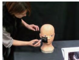
化粧筆の塗りムラ評価（画像解析）、筆の動き解析（高速度カメラ）
