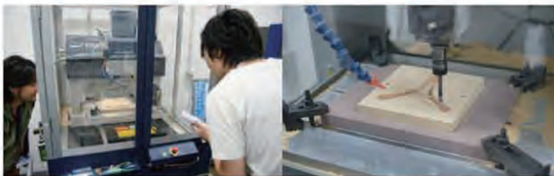
都産技研システムデザインセクターの切削モデリングマシンを利用した、スピーディーな試作。ジュラルミンの切削も行った。
