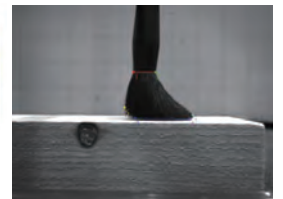
化粧筆の塗りムラ評価（画像解析）、筆の動き解析（高速度カメラ）
