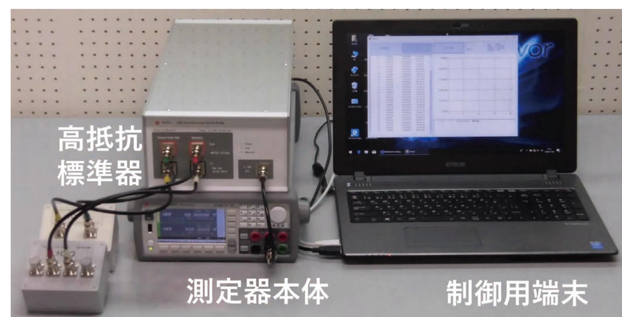
株式会社サンジェムとの共同研究で開発した高精度高抵抗測定器
