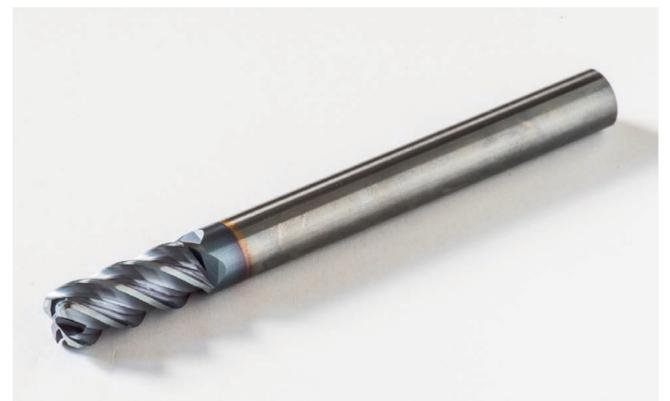
NC工具研削盤による自社製作工具
